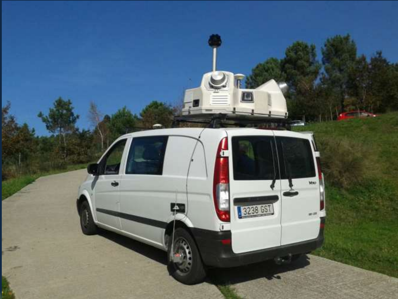
Equipo Mobile Mapping montado sobre vehículo
